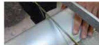
2. Corte o Spoiler no local marcado.
