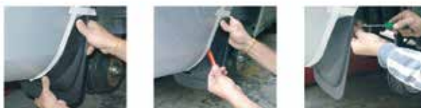
1. Posicione no carro e marque o local de instalação. 2. Após dobrar a ponta do liner, posicione e cole. 3. Parafuse pela parte interna.
